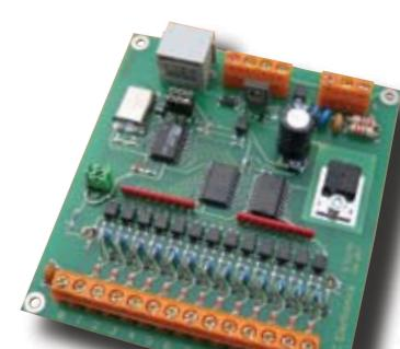
• 5102001 модуль интерфейс бинарным входом и серийным SSL выходом
